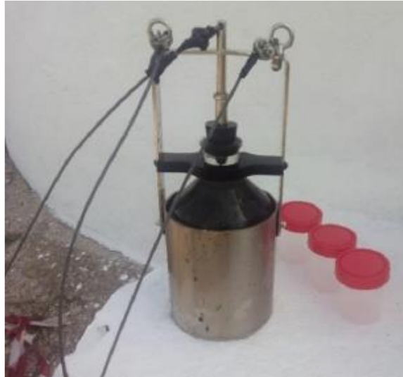
Figura 2- Botella empleada para la toma de muestras en profundidad.
