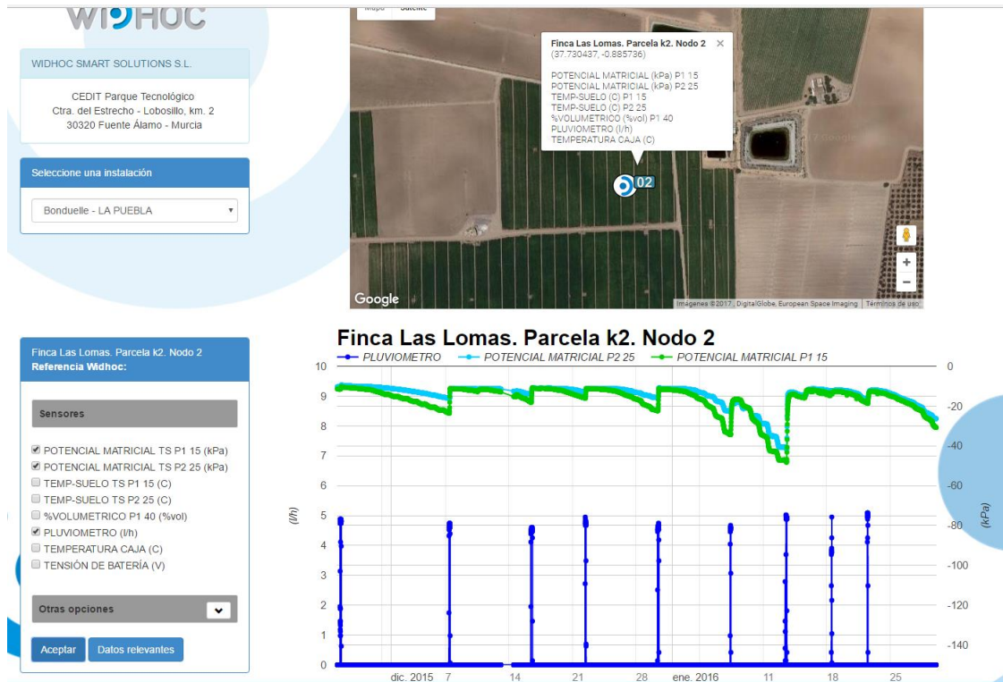
Figura 3 – Vista del frontend del sistema de cloud computing que utiliza el equipo agronómico de Widhoc para preparar los informes con las recomendaciones de riego a sus clientes.
