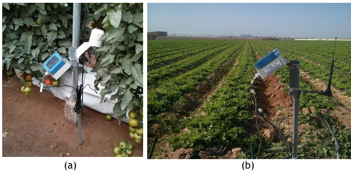
Figura 2 – Vistas de ensayos realizados. (a) Fotografía de uno de los nodos en un cultivo de tomates. (b) Fotografía de uno de los nodos en un cultivo de escarola.
